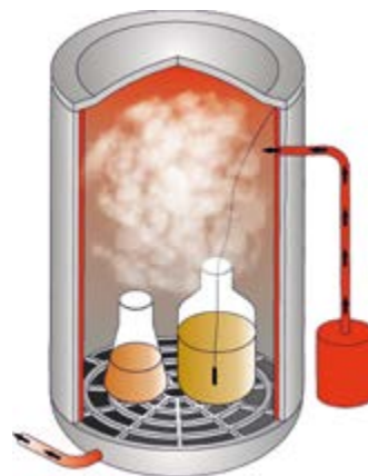
Dampferzeugung mittels integriertem Dampfgenerator
